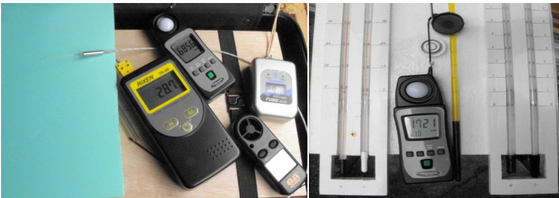
図 7・8 測定に使った道具や機器 左端の細い針が HOGA 超極細温度計プローブ \phi 0.5mm・次がデジタル温度計・中央上部が照度計・その右は温度データロガー(FUSO-8828)・下が簡易風速計である。照度計は太陽に垂直に向ける必要があり、あらかじめ太陽に向けた計測板の上に置いて Max を測定した。
